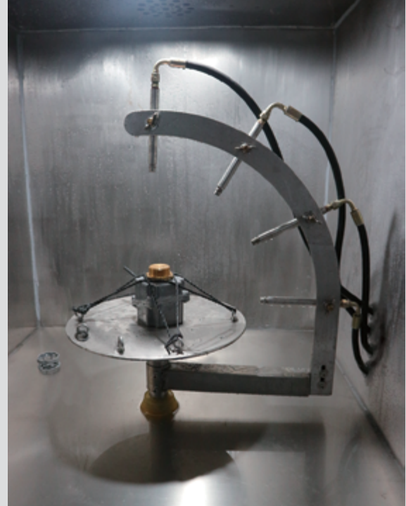
Boitier en cours d'essai IPx9K
