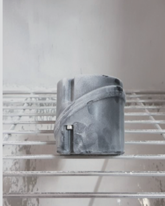
Boitier en cours d'essai IP6x
