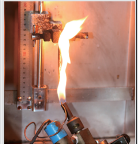
Eprouvette durant l'essai UL94 VO
